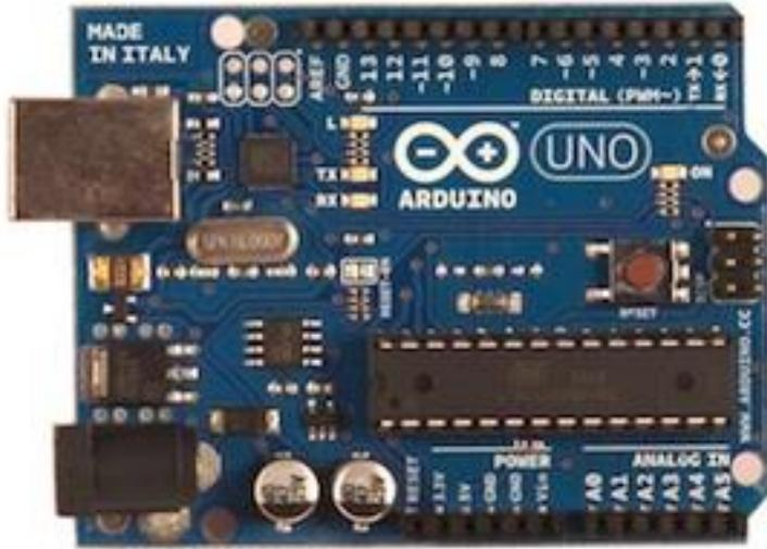
La **carte Arduino Uno** est une carte à microcontrôleur basée sur l'ATmega328P. Elle dispose :
